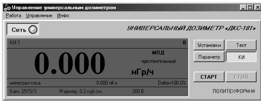
Измерения проводите аналогично п.11.4. При этом в поле «Delta» будет отображаться абсолютное отклонение показаний прибора от паспортных характеристик в %. Следует отметить, что паспортные характеристики автоматически корректируются в течение межповерочного интервала по закону радиоактивного распада, и каждой штатной камере соответствует свой список контрольных источников.
